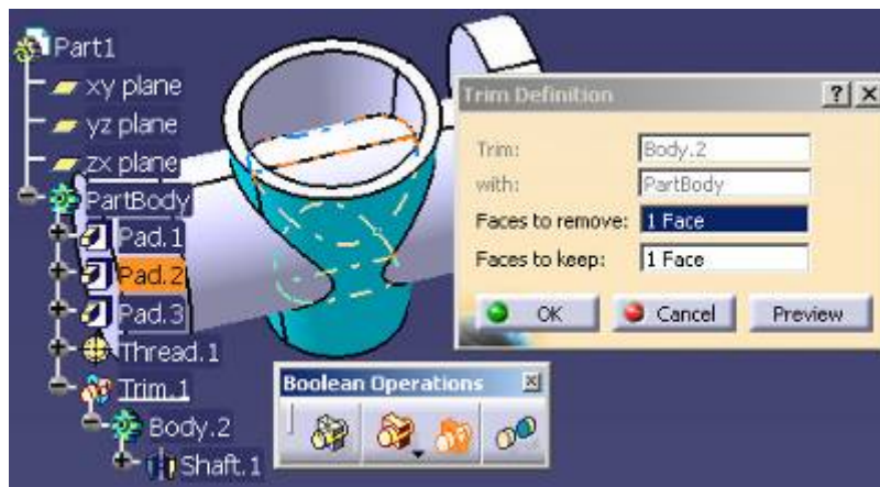
Fig. 3.163. Extragerea volumului de material pus în comun de cele două corpuri
