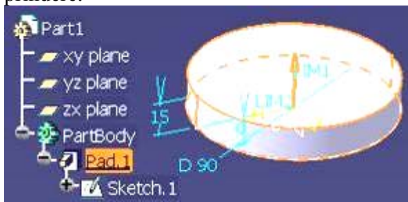
Fig. 3.158. Obținerea primului cilindru (corpul flanșei)
