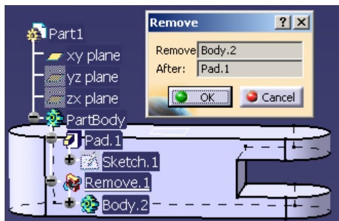
Fig. 3.151. Extragerea corpului Body.2 din corpul PartBody
