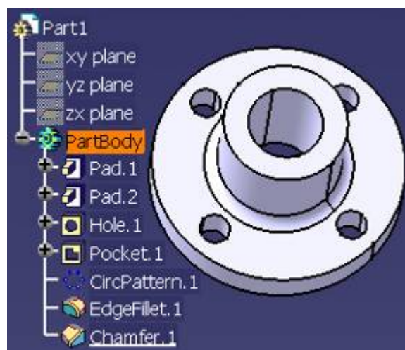
Fig. 3.137. Modelul final al flanșei
